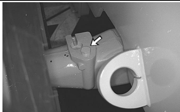
Рисунок 2 g00110469 Пробка заливного отверстия заднего дифференциала и бортовой передачи
