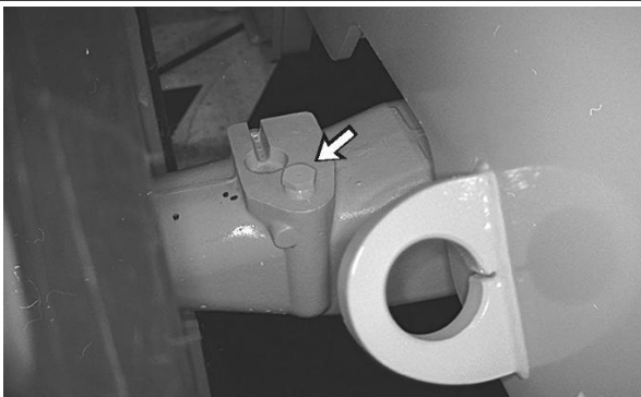
Рисунок 2 g00110469 Пробка заливного отверстия заднего дифференциала и бортовой передачи
